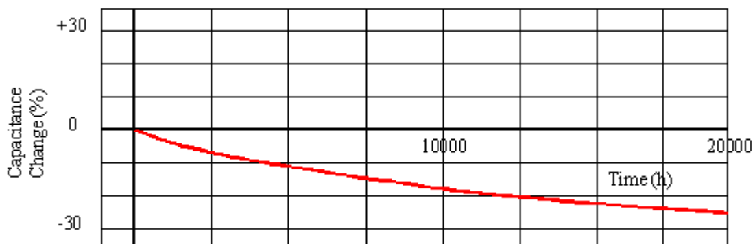
Bild 14: Kapazitätsänderung als Funktion der Zeit bei einer Betriebstemperatur von 105°C.
