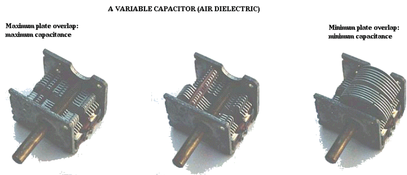
Bild 22: Doppeldrehkondensator in verschiedenen Rotorstellungen (6.35mm-Achse)
