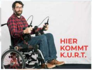
Ein neuartiger und leistungsstarker kurbelbasierender Rollstuhlantrieb mit Mushelkraft
