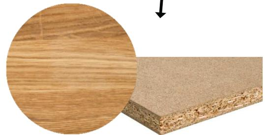
Die Klappe wird aus einer Spanplatte hergestellt, die mit Buchenholz furniert wird.
